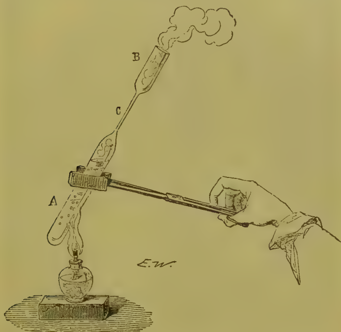
Fig. 204. Preparazione di una soluzione soprasatura di solfato di soda.
